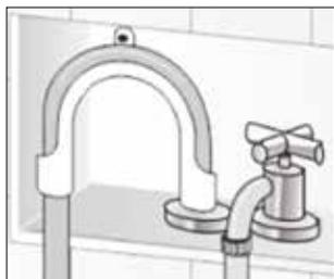
Убедитесь, что, когда сливной шланг вставлен в сливную трубу, его конец не углублён более чем на 15 см. Если шланг вставлен слишком глубоко, это может вызвать слив воды из барабана в результате самосифонирования, т.е. регулярное опустошение барабана в момент наполнения.
