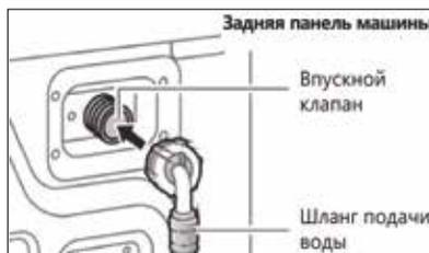
**⚠ ПРЕДУПРЕЖДЕНИЕ! Стиральную машину можно подключать только к крану холодной воды.**
