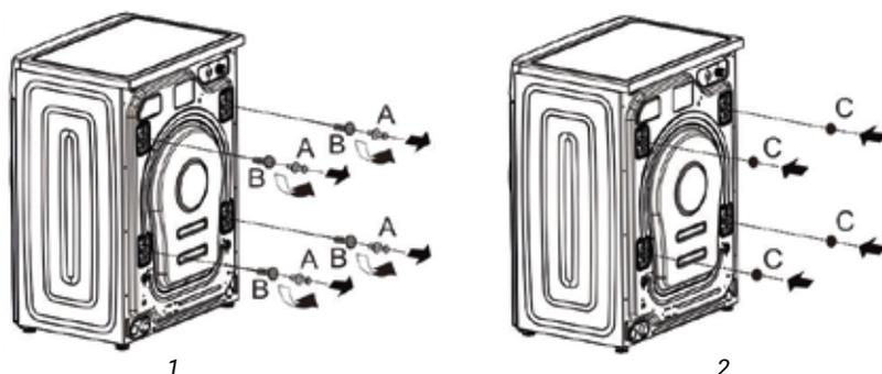
**⚠ ВНИМАНИЕ!** Сохраняйте транспортировочные болты. Они могут потребоваться при возможной транспортировке машины в будущем. В этом случае установите транспортировочные болты в обратной последовательности.
