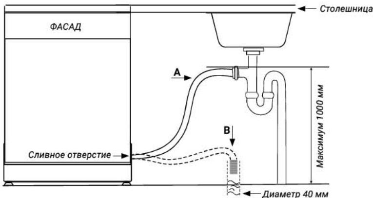
**⚠ ВАЖНО!** Закрепите сливной шланг как при варианте А, так и при варианте В.
